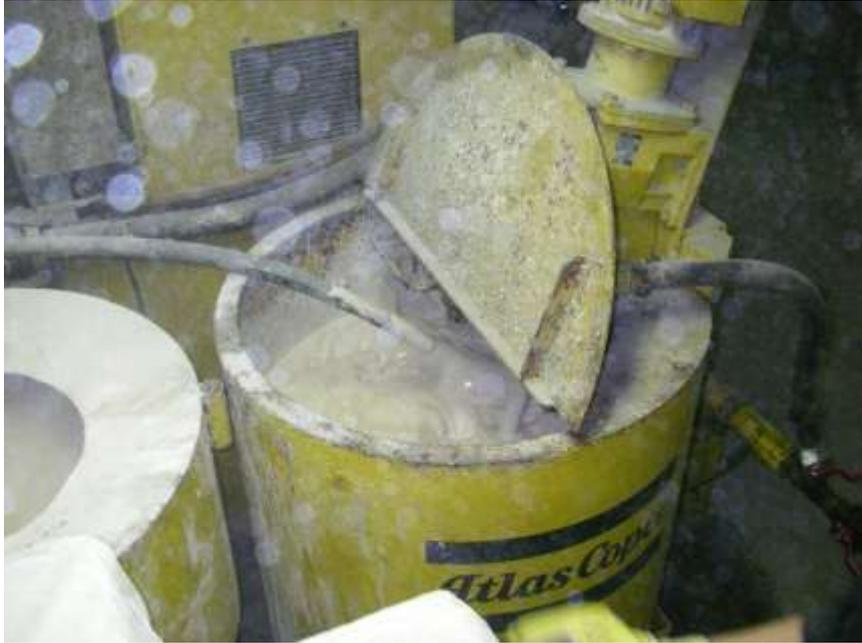
Abb. 3.16. Einsatz der K+S Mischmaschine UNIGROUT 200-100E-02 von Atlas Copco (Leistung: ca. 3 m<sup>3</sup>/h; Max. Pumpenkapazität: 0 – 100 l/min; CEMAG 401E – Rührwerk mit 400 l Fassungsvermögen): Pumpen der MgOH<sub>2</sub>-Suspension in den Vorratsbehälter.
