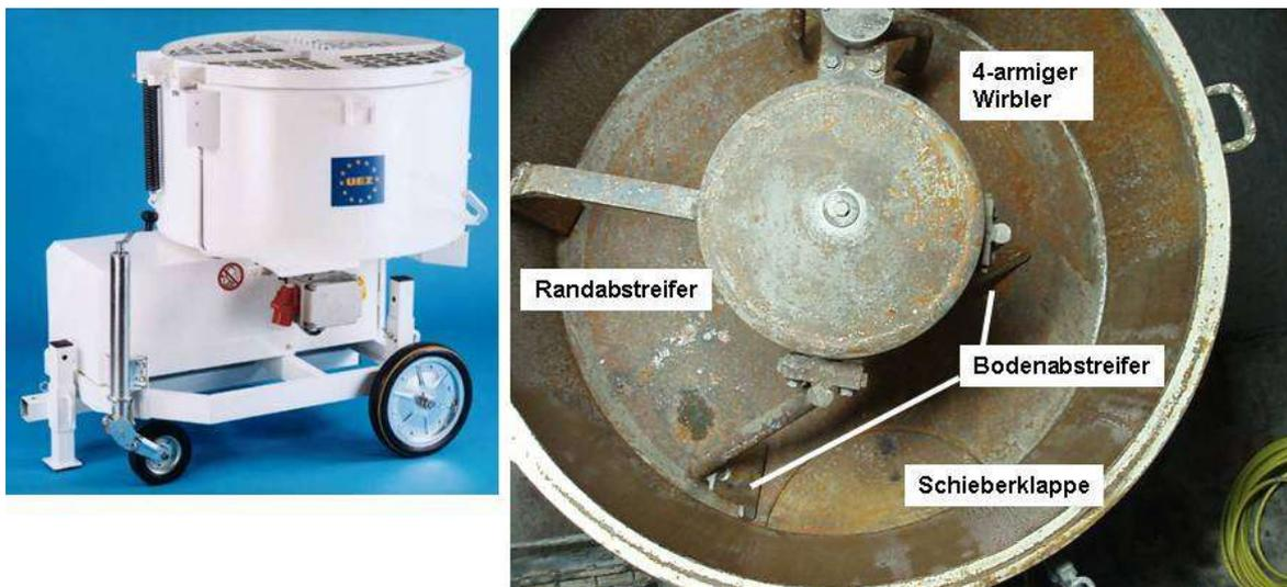
Abb. 3.14. UEZ-Zwangsmischer. (li.) Mischer mit Mischtrommel auf Lastrahmen mit Handdeichsel. (re.) geöffnete Mischtrommel mit Mischarmen.
