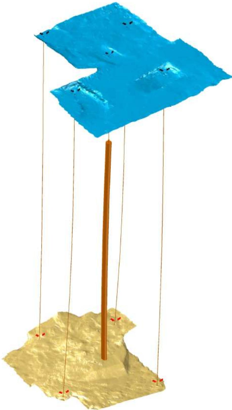
Abb. 3.6. 3D-Darstellung des Versuchsortes – Morphologie und Lage der AE-Bohrungen: (blau): Oberkante der 1. Sohle; (braun) Firste der 2. Sohle.
