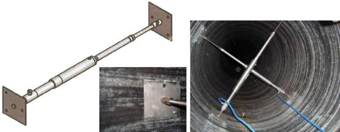
Abb. 3.20. GLÖTZL-Konvergenzextensometer 1300mm im Teleskop. (li.) Schemazeichnung (Quelle GLÖTZL); (re.) Untertagesituation mit Detailaufnahme zur Befestigung der Druckplatten.
