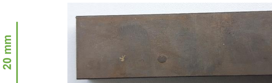
Abbildung 28: Blistering an Probe 714-1 (Grundwerkstoff)
