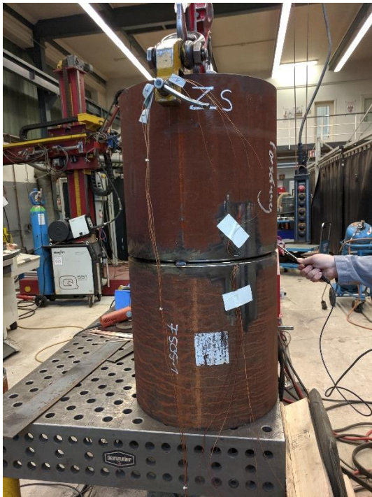
Abbildung 20: Zu verschweißende Proberohre (links), aufgepunktete Thermoelemente an den Schweißnahtkanten vor dem Schweißen (rechts)
