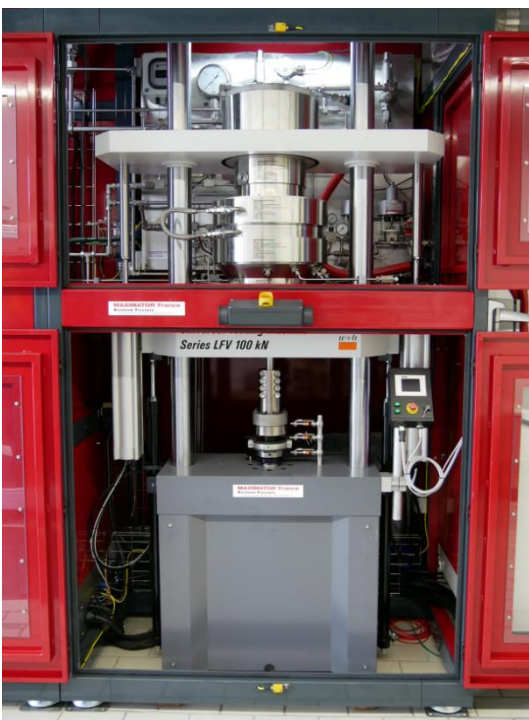
Abbildung 23: 1.000 bar Autoklav zur mechanischen Probenbelastung in Wasserstoffatmosphäre
