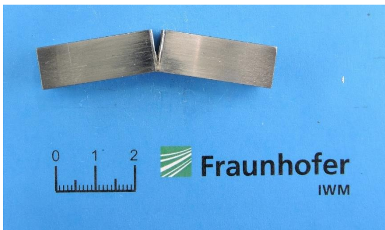
Abbildung 56: Bei 200 bar getestete Single Edge Notched Bending- (SENB-)Probe
