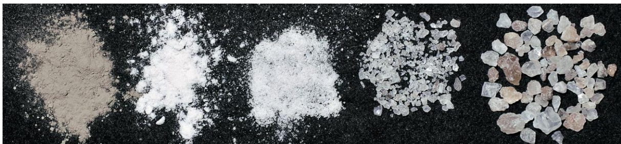
Abbildung 7: Verwendete Kornfraktionen (Salzgrus und Ton) und deren Korngrößenverteilung
