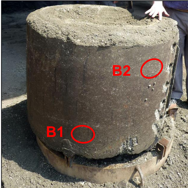
Abbildung 31: Im Vorversuch gewonnene Probe mit den Ansätzen der Kernbohrungen
