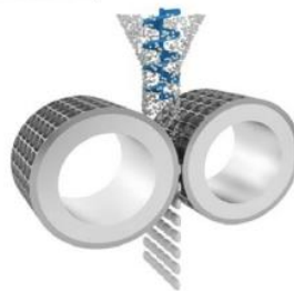
Abbildung 10: Herstellung von kissenförmigen Salzbricketts aus den Fraktionen "B6" und "Feinsalz" durch Walzenpressung bei 110 °C
