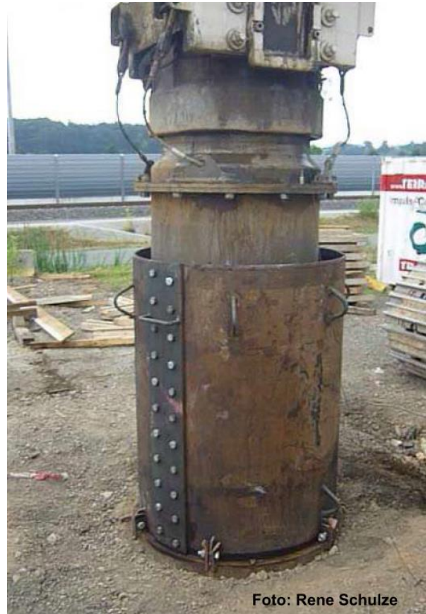
Abbildung 30: Halbtechnischer Verdichtungsversuch mit der Impulsverdichtung (TerraMix)
