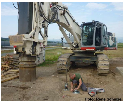
Abbildung 30: Halbtechnischer Verdichtungsversuch mit der Impulsverdichtung (TerraMix)
