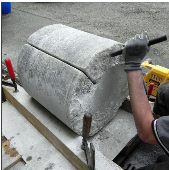
Abbildung 71: Freilegen der Bitumendichtung beim Versuch BIT-01
