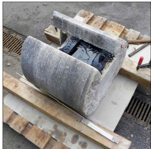
Abbildung 72: Freigelegte Bitumendichtung beim Versuch BIT-01
