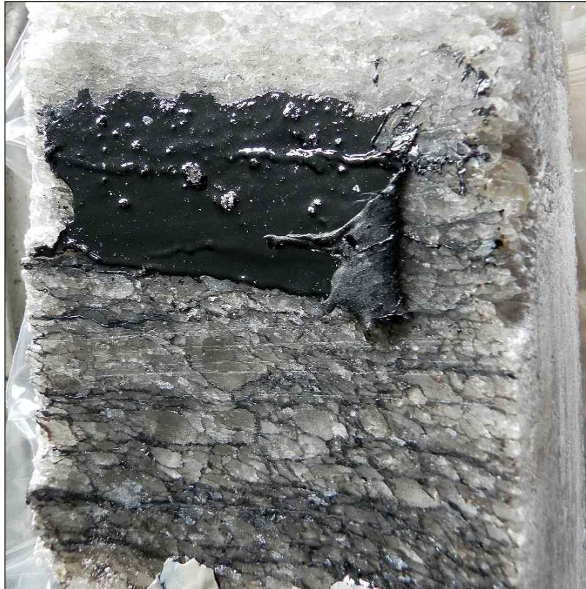
Abbildung 74: Kontaktbereich Destillationsbitumen - Steinsalz beim Versuch BIT-02
