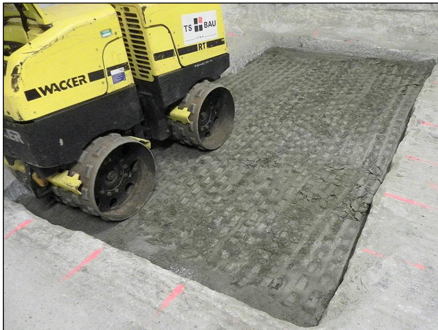
Abbildung 29: Oberflächenstruktur nach der Verdichtung mit der Grabenwalze (Versuchsmulde 2, STG-1 - EBSM)
