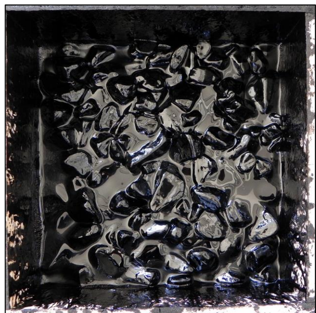
Abbildung 19: Oberfläche des Mischgutes mit einem optimalen Bitumengehalt direkt nach dem Einbau und Abkühlung
