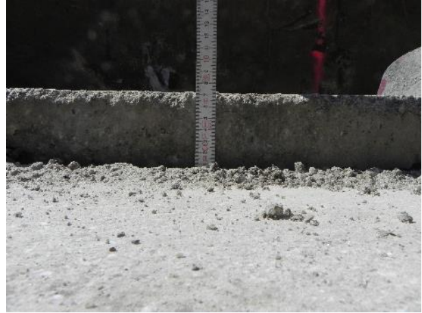
Abbildung 51: Stanzeffekt der Impulsverdichtung im Gesenkversuch 2017
