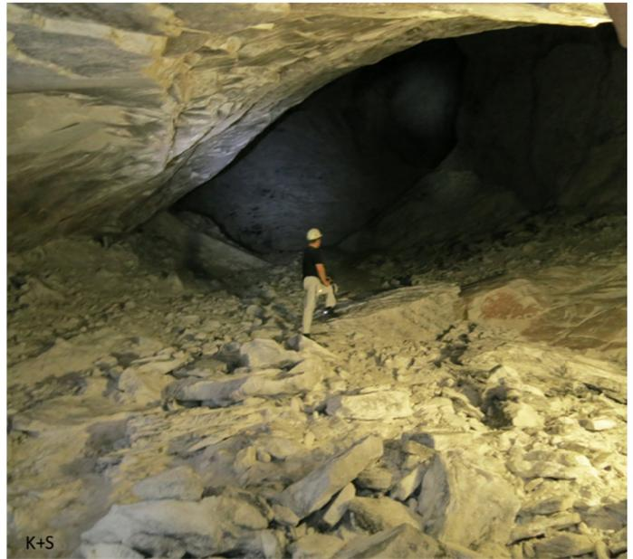
Figure 4: Outburst cavity in Unterbreizbach
