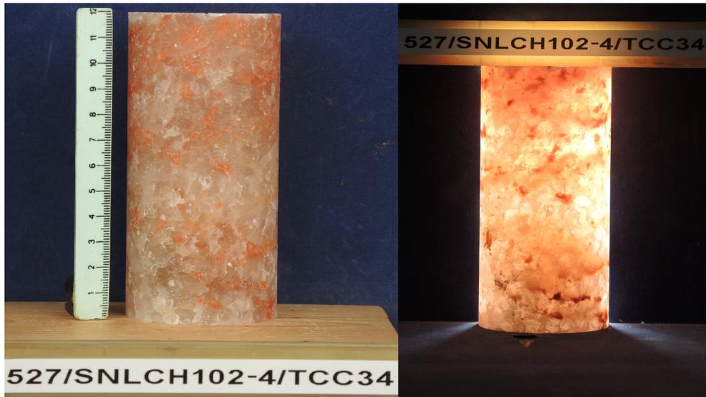
Abbildung 11: Prüfkörper für den Langzeitversuch TCC34 in Auf- und Durchlicht.
