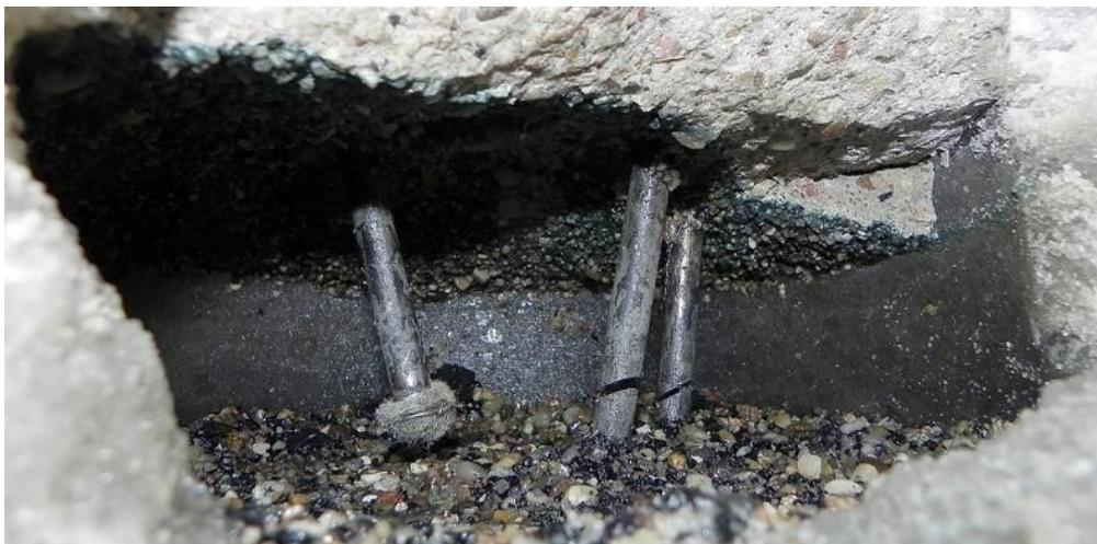
Abbildung 27: Entleerte Kontrollkammer mit getrennten Röhrchen der Druckkammer bei BIT-2
