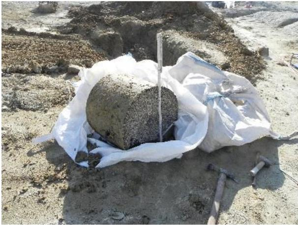
Abbildung 108: geborgenes Asphaltelement des Versuchs ASP-4
