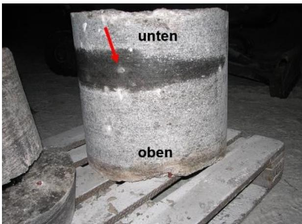
Abbildung 30: Flüssigkeitsausbreitung beim Versuch BIT-2 sichtbar am Kernsegment BIT-1
