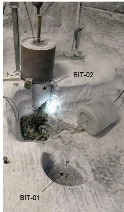
Abbildung 26: Überbohren der Versuche BIT-1 und BIT-2
