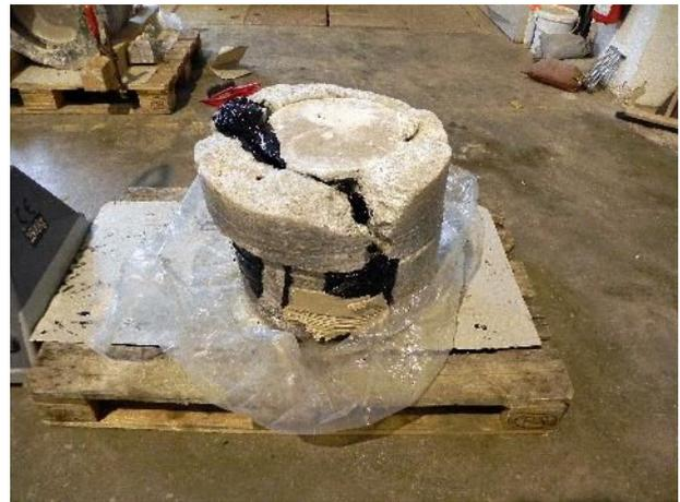
Abbildung 29: Kernsegment mit Bitumendichtung beim Versuch BIT-2
