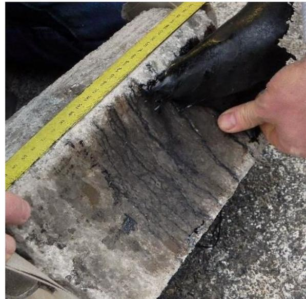
Abbildung 36: Abziehen des anhaftenden Destillationsbitumens des Salzstückes bei BIT-1
