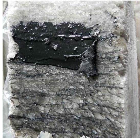
Abbildung 39: Kontaktbereich Destillationsbitumen - Steinsalz beim Versuch BIT-2
