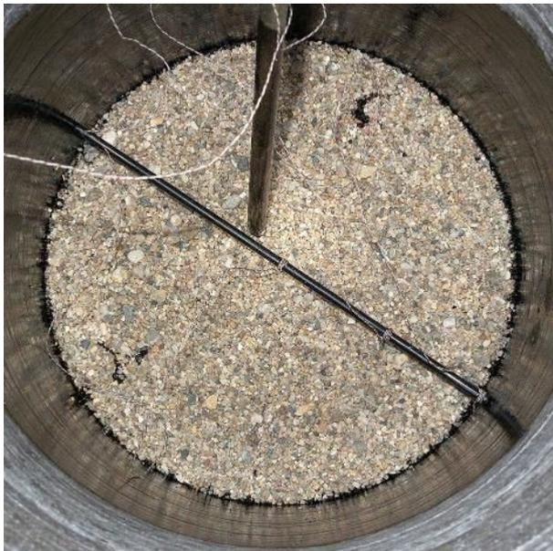
Abbildung 7: Fertig gestellte Druckkammer und die positionierten Temperaturgeber der unteren Sperrbitumenschicht
