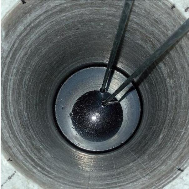
Abbildung 18: Oberflache des Abdichtbitumens AZALT 70/100 ca. 4 h nach Einbau
