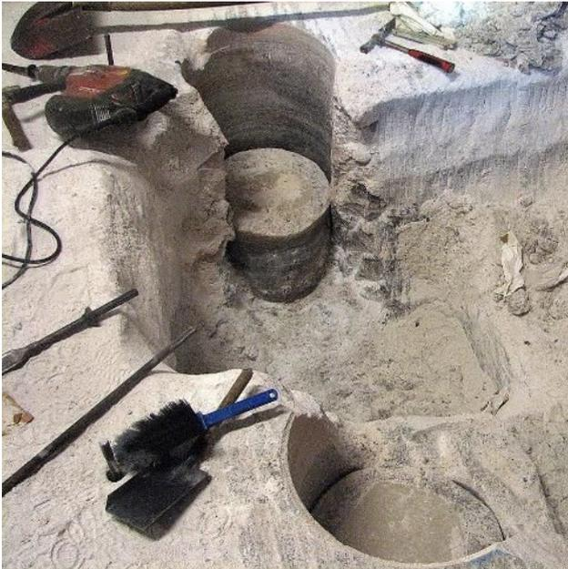
Abbildung 28: Überbohrte Bitumendichtung beim Versuch BIT-2
