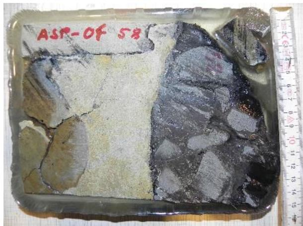
Abbildung 112: präparierte Scheibe eines Konturbereichs aus dem Versuch ASP-4
