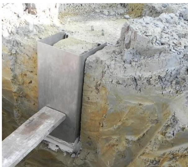
Abbildung 107: Präparation einer Probe aus dem Konturbereich des Versuchs ASP-4
