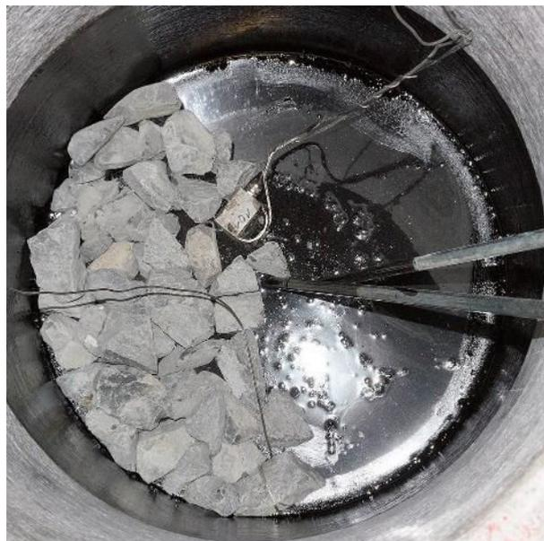
Abbildung 43: Oberfläche der abgekühlten unteren Sperrschicht mit dem teilweise eingebauten Schotter und dem Druckgeber D1
