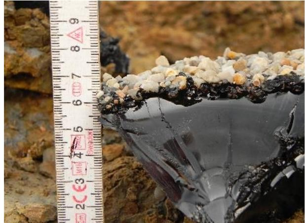
Abbildung 111: abgeschlagenes Bruchstück aus der oberen Sperrbitumenschicht des Versuchs ASP-3
