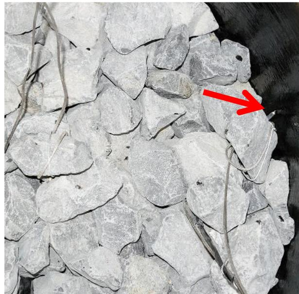
Abbildung 46: Position des Thermoelements T4 an der Bohrlochkontur
