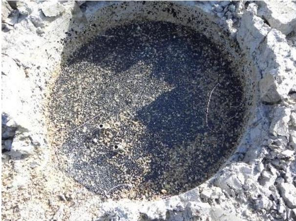
Abbildung 110: freigelegte Oberfläche der Sperrbitumenschicht zur Kontrollkammer des Versuchs ASP-4
