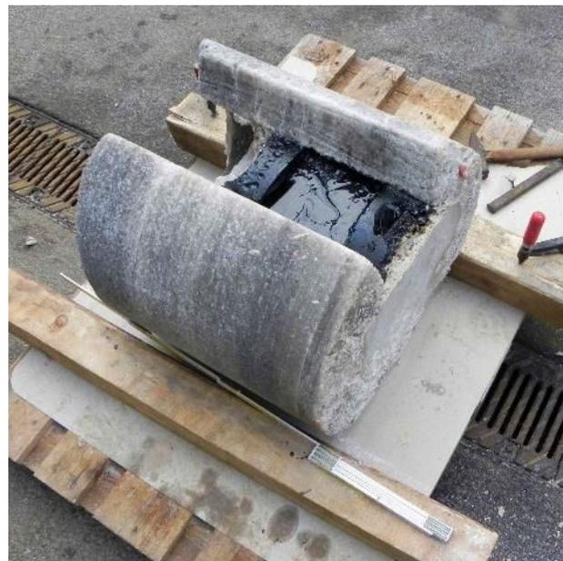
Abbildung 33: Freigelegte Bitumendichtung beim Versuch BIT-1
