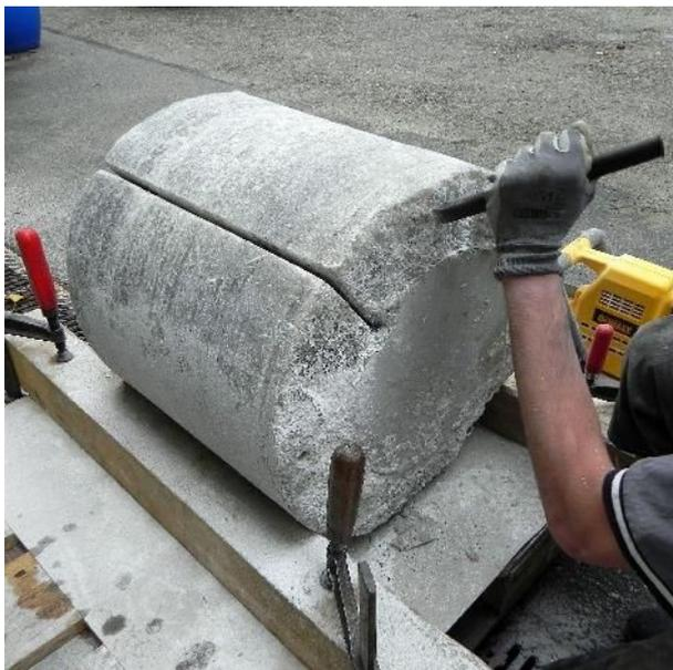
Abbildung 32: Freilegen der Bitumendichtung beim Versuch BIT-1
