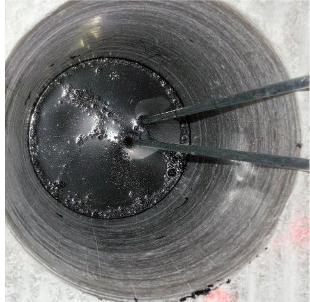
Abbildung 19: Oberflache der abgekuhlten oberen Sperrschicht
