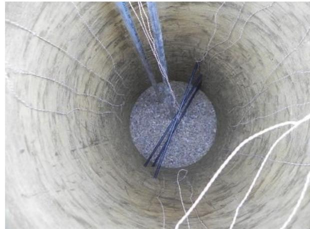
Abbildung 68: eingebaute Thermolemente
