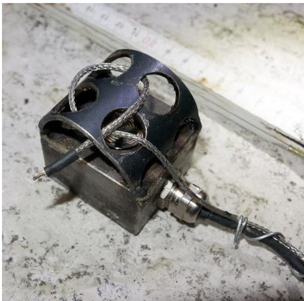
Abbildung 42: Druckgeber kombiniert mit Thermoelement
