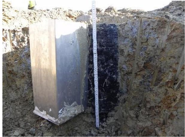
Abbildung 109: freigelegter Abschnitt des Asphaltelements des Versuchs ASP-3
