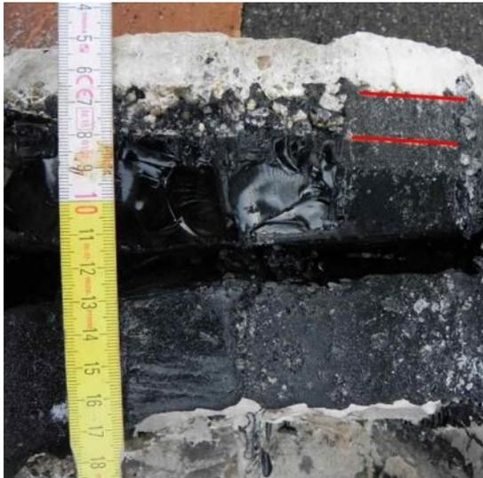
Abbildung 38: In Kontrollkammer hineingepresstes Oxidationsbitumen beim Versuch BIT-2
