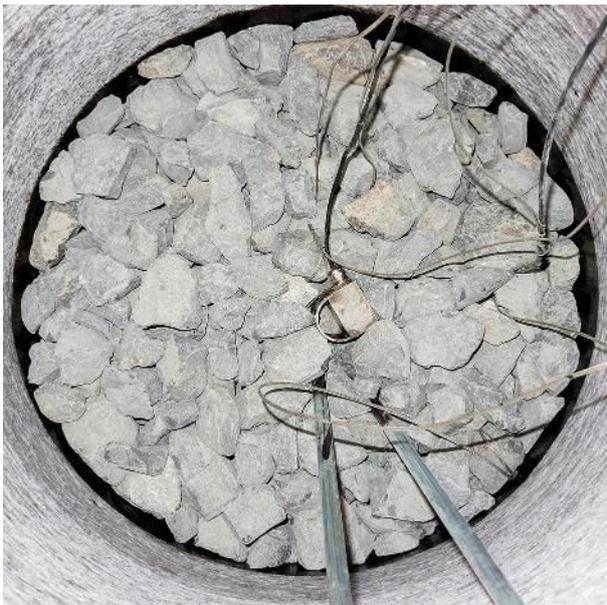
Abbildung 45: Oberfläche des eingebauten Schotterelements mit dem Druckgeber D2
