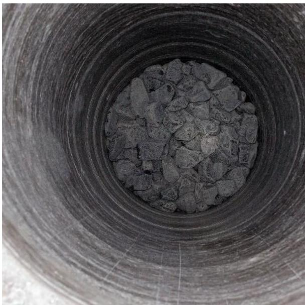
Abbildung 16: Rundkornsotter in der Druckkammer
