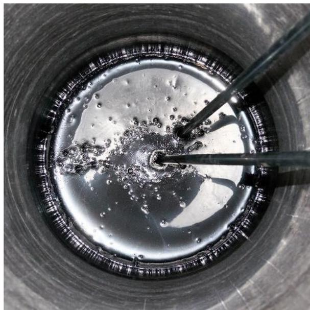
Abbildung 17: Oberfläche der abgekühlten unteren Sperrschicht aus STELOX 85/25
