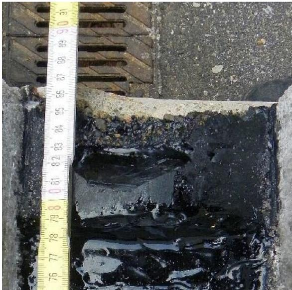
Abbildung 35: In Kontrollkammer hineingepresstes Oxidationsbitumen beim Versuch BIT-1
