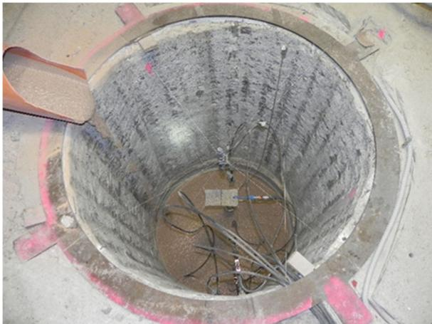
Abbildung 22: Einbringen MgO-Beton C3
