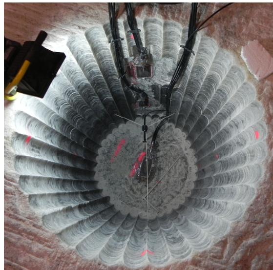
Abbildung 2: Versuchshohlraum mit den ersten eingebauten Plattendruckgeber und einem Betondehnungsgeber
