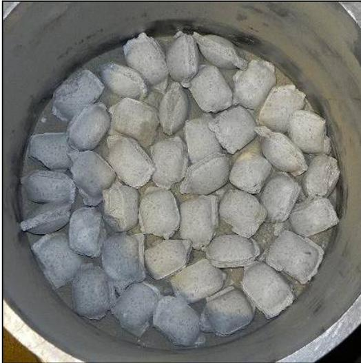
Abbildung 2-31: Eingebaute Lage der Grobkomponente (Salzbricketts)
