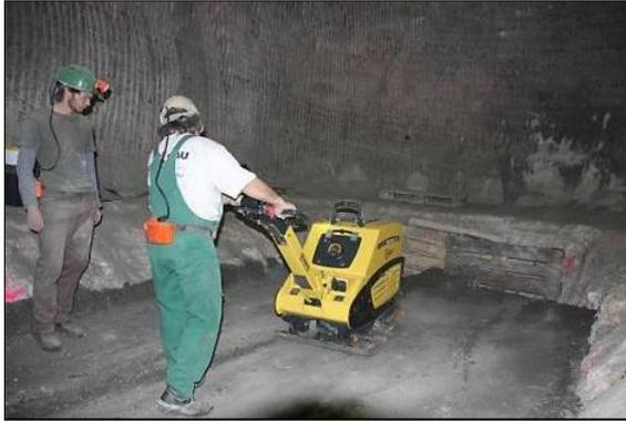
Abbildung 2-1: Verdichtungstest mit Rüttelplatte in der Grube Teutschenthal [Melzer 2011]
