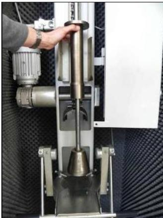
Abbildung 2-7: Aufbau des Marshallverdichters mit dem Hammer und dem Fallgewicht (in der Hand gehalten)
