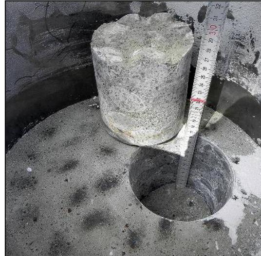
Abbildung 2-32: Probenahme des verdichteten binären Gemisches nach dem Ödometerversuch
