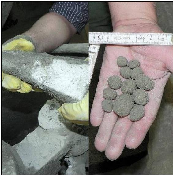
Abbildung 2-17: Typische Anbackungen (links) und Granalien (rechts) bei konventionellen Zwangsmischern
