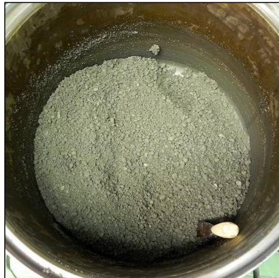
Abbildung 2-18: Typisches Mischgut bei Nutzung eines Intensivmischers
