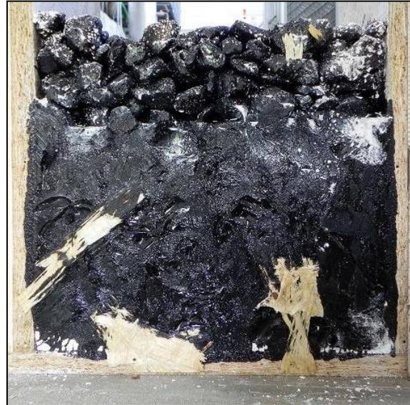
Abbildung 6-30: Querschnitt durch das eingebaute Mischgut
