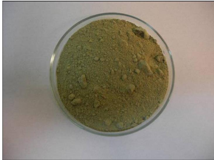
Abbildung 7-11: Zerkleinerte Calcigel-Presslinge
