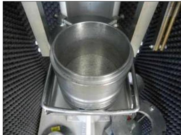
Abbildung 2-8: Zylinderförmige Form des Marshallverdichters
