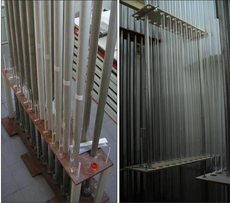
Abbildung 7-1: Steigapparatur für die Materialuntersuchungen
