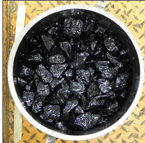
Abbildung 6-19: In den Ödometertopf eingebaute bitumenumhüllte Schotterprobe BK-32/56
