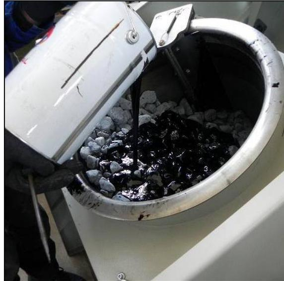
Abbildung 6-28: Herstellung des Mischgutes in einem speziellen Mischer
