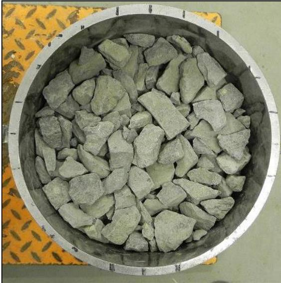
Abbildung 6-18: In den Ödometertopf eingebaute Schotterprobe BK-32/56
