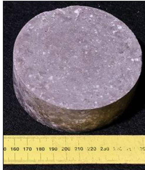
Abbildung 2-14: Typische Marshall-verdichtete Probe aus einem Salzgrus-Ton-Gemisch
