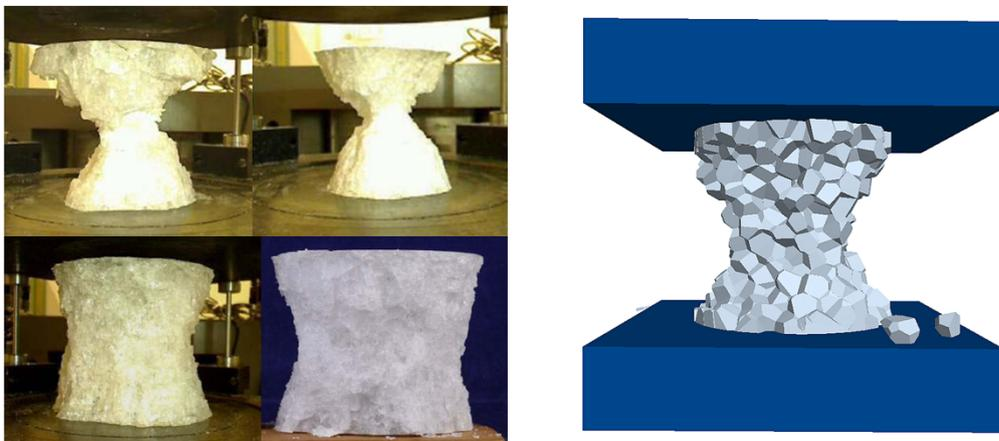
**Abb. 7.4:** Prüfkörper nach weggeregeltem Druckversuch im Laborversuch (links) und der Simulation (rechts). Abschaltungen jeweils nach Versuchsende entfernt.
