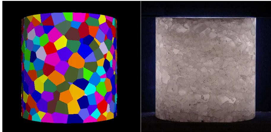
**Abb. 7.3:** Zylinderförmiger Probekörper in der diskontinuumsmechanischen Modellierung durch Voronoi-Zerlegung (links, verschiedene Blöcke farblich markiert) im Vergleich zur realen Probe (rechts).
