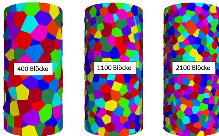
**Abb. 7.1:** Diskontinuumsmechanischer zylindrischer Probenkörper mit drei verschiedenen mittleren Korngrößen.
