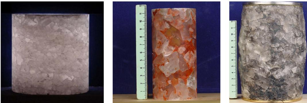
**Abb. 2.1:** Steinsalzproben mit deutlich erkennbarer Mikrostruktur.
